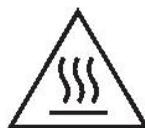
15. Věnujte pozornost žehlicí ploše, neboť žehlicí plocha je během práce s žehličkou a po jejím skončení horká. Dbejte na to, aby se napájecí kabel nedostal do kontaktu s žehlicí plochou žehličky. Před uložením žehličky počkejte, až se úplně ochladí.
